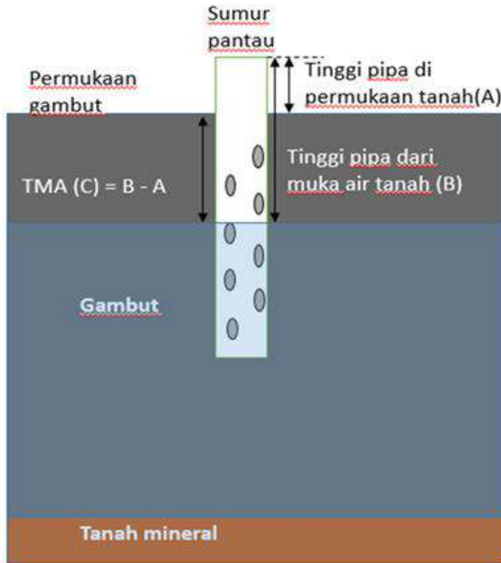
Gambar 12. Penampang sumur pantau tinggi muka air tanah gambut (Sumber: Basuki dkk. 2020).
