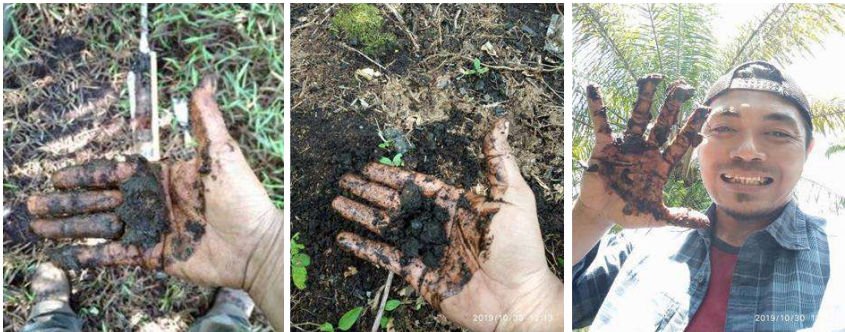
Gambar 4. Kematangan gambut fibrik, hemik dan saprik yang dapat ditentukan di lapangan dengan metode peremasan bahan gambut yang basah.
