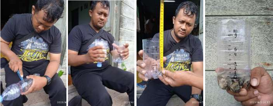
Gambar 16. Proses pembuatan alat pengukur intensitas curah hujan sederhana.
